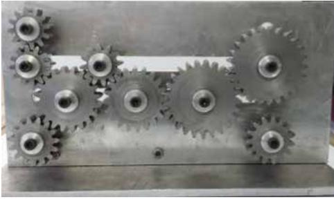
Figura 6: Ensamble de banco de transmisión
