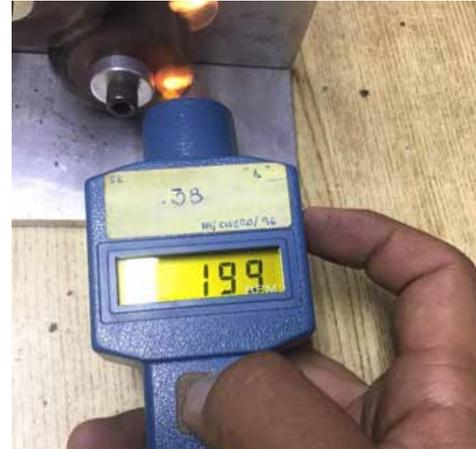
Figura 9: Velocidad de salida
