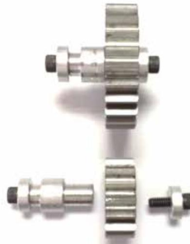
Figura 4: Conjunto de eje y engrane
